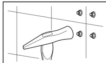
注2：锚固螺栓埋入混凝土的埋入量50mm以上。不满足50mm的情况，扶手会脱落，墙体会破坏。
