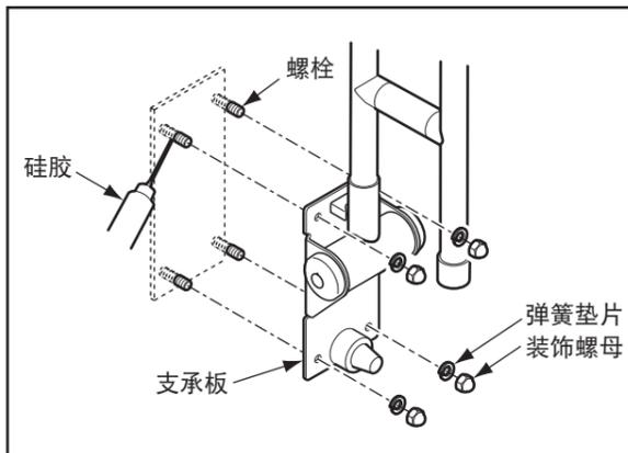
将建议在安装孔周围涂布硅胶。
