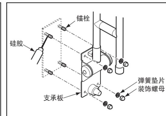
⑧安装完后，确认墙壁和扶手没有间隙。
