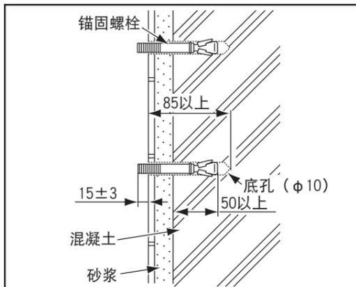
⑤安装完后，确认墙壁和扶手没有间隙。
