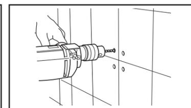
注3：必须安装厚度60mm以上的加固木。不满足60mm的情况，扶手会脱落，墙体会破坏。
