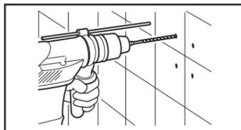
注1：在混凝土上，请使用 $\Phi 10\text{mm}$ ，深85mm以上的开孔钻头，钻头的直径过大，偏心大，扶手不能牢固地固定。
