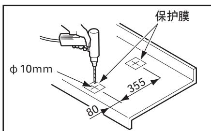
人造大理石上，请使用Φ10mm的钻头，直径过大的话，大理石台面容易破裂。
