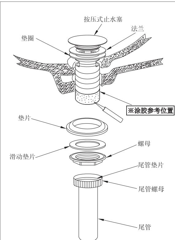
如图所示，将法兰和垫圈放入洗脸盆的安装孔中，与垫片接触的螺纹部整周均匀涂抹适量的长效防霉型中性硅酮密封胶，依次将垫片、滑动垫片、螺母安装到法兰的螺纹上，再将螺母拧紧，使排水金具与洗面盆充分紧固，最后拧紧尾管螺母将尾管部分固定在法兰上。
