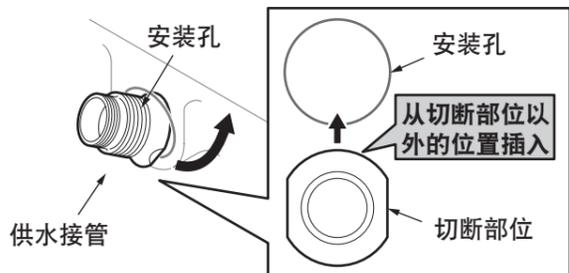
②将裙式密封圈插入安装孔中，装上供水接管。
