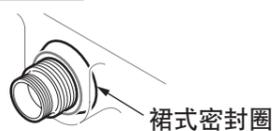
③按照橡胶密封圈（大）、滑动垫圈（大）的顺序安装供水接管。
