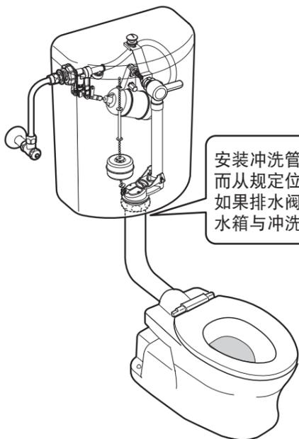
安装冲洗管后，有可能发生排水阀共转而从规定位置偏离，请仔细确认。
