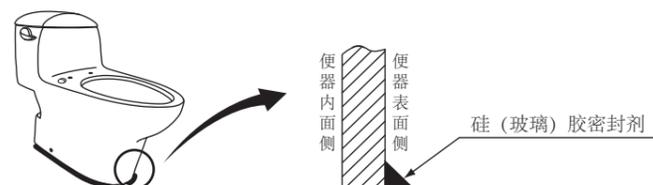
警告: 禁止使用环氧树脂或硬化后体积变大的密封材料。
