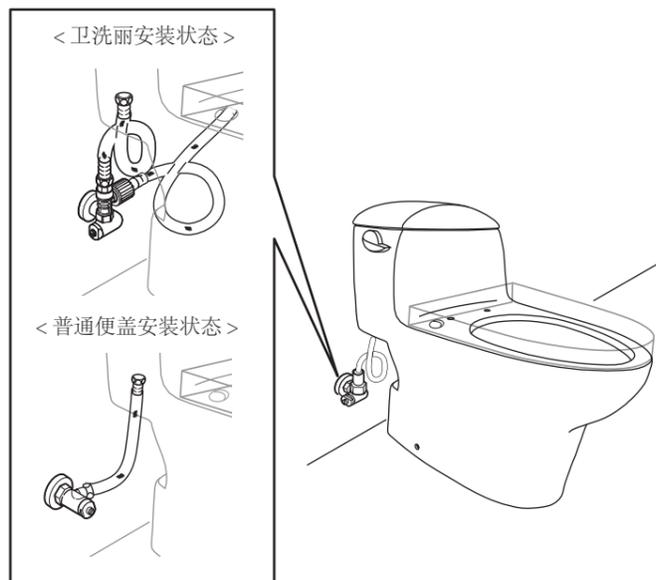
试运转后请对所有的安装部位进行是否漏水的确认。
