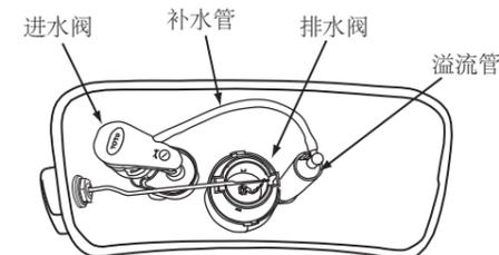
注意: 务必使补水管的补水直接流入溢流管中, 否则会严重影响冲洗效果, 请仔细确认!
